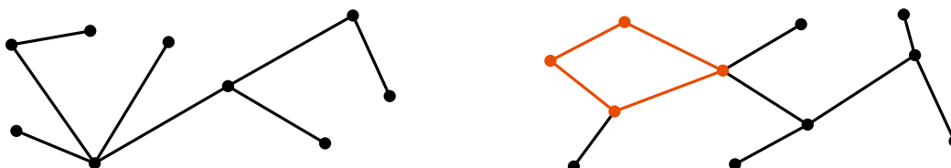
Abbildung 6.14: Der linke Graph ist ein Beispiel für einen Baum. Der rechte Graph ist kein Baum, weil er den farbigen Kreis enthält.
